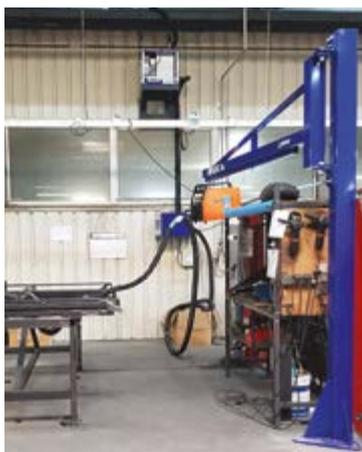
Les potences SIMPLAXE sont composées d'un simple pivot avec un support pour dévidoir, d'un poids maximum de 50kg, sur rail. Le rail est équipé de galets et de chariots de fixation 255 A permettant la fixation du faisceau de puissance ainsi que du flexible d'aspiration.
