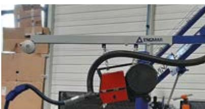
L'équilibreur de charge s'installe sur la potence TWINAXE et permet de mettre en suspension la torche aspirante tout en améliorant le dévidage de fil.
