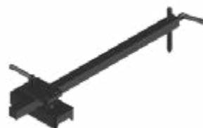
**Outil de positionnement des rails parallèles au joint de soudage**
