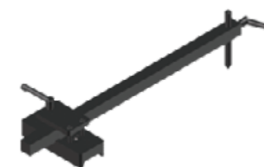
Outil de positionnement des rails parallèle au joint de soudage AO200113.000
