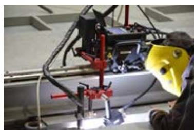
Soudage TIG d'une plaque de titane
