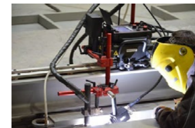
Soudage TIG d'une plaque de titane
