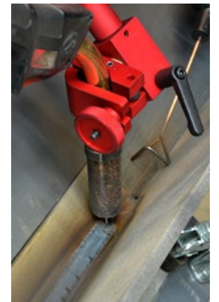
Le suivi de joint fonctionne avec et sans oscillation
