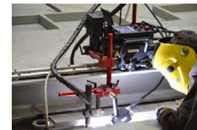
Soudage TIG d'une plaque de titane
