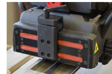
Les protections en silicone protègent contre la saleté et les éclaboussures
