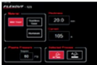
**Gestion du procédé** – Tous les paramètres sont contrôlés à partir de l'interface en fonction du **simple choix du matériau et de l'épaisseur** simplifiant la mise en œuvre de la découpe plasma. Plusieurs fonctions augmentent la productivité du cycle et compensent automatiquement l'usure des consommables.
