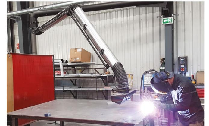
La structure porteuse extérieure, réalisée en une seule pièce, est fabriquée en acier et en alliage anodisé pour garantir la résistance dans le temps malgré l'exposition continue aux fumées et pour augmenter la légèreté de l'ensemble.
