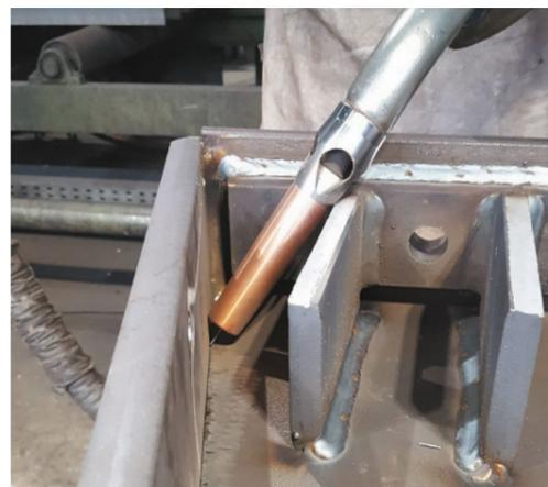
Les buses gaz longues pour torches 300, 350 et 380 permettent l'utilisation même dans les endroits les plus confinés. Elles mesurent 4 cm de plus que les buses à gaz standard.
