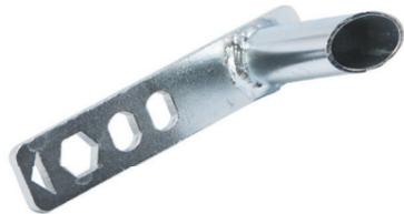
Les clés équarri-soirs permettent le nettoyage de la buse gaz et du diffuseur sans démontage des pièces de tête. De plus, elles permettent le serrage du diffuseur et du tube contact sans détérioration.
