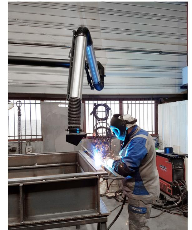
Bras ARMOWELD et capteur laminaire REVOLFLOW
