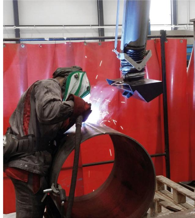
Bras aspirant ARMOWELD et capteur REVOLFLOW
