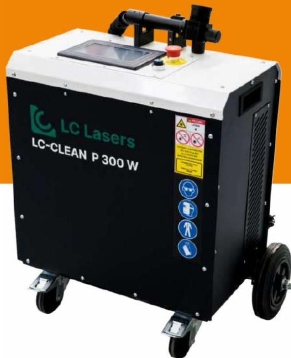
LC CLEAN PRO est un équipement de dernière génération qui utilise le laser comme système de décapage pour l'élimination des impuretés tout en préservant le substrat intact. Avec cet équipement de nettoyage laser, nous pouvons enlever la peinture, la rouille, les impuretés, effectuer des nettoyages en profondeur et travailler dans différents environnements. C'est véritablement une révolution dans le domaine du nettoyage industriel.
